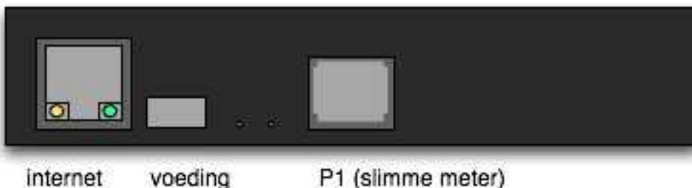
Figuur 5: Schematische weergave van de aansluitingen van de Upp Box
