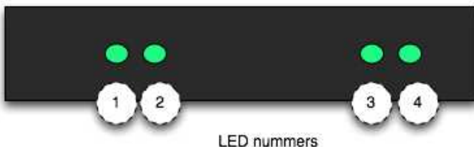
Figuur 6: Schematische weergave van de LED's van de Upp Box
